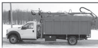
Chargeuse MÉTAVIC adaptée pour camion
