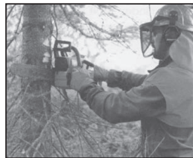
Figure 7 - Ne pas tenir la scie à chaîne plus haut que les épaules
